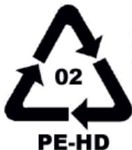
**HDPE:** Polyéthylène haute densité ou High Density Polyethylene
