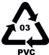
**PVC :** Le polychlorure de vinyle. C'est le 3<sup>ème</sup> plastique utilisé dans le monde. Environ 40% est utilisé pour les profils de fenêtre, tuyauteries, revêtements de sol et toiture.
