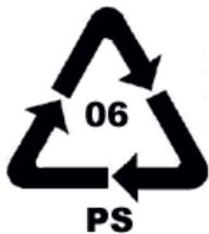
**PS :** Polystyrène. Dans le domaine électronique on se sert du polystyrène pour sa bonne qualité d'isolation. On l'utilise pour la fabrication d'appareils électroniques, prises, bobines et boîtiers (High Impact Polystyrène, HIPS).
