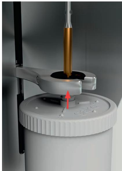
Die Mischeinheit wird von unten eingeschoben...
